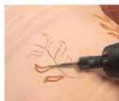
**FRESAS DE ALTA VELOCIDAD** Las fresas de alta velocidad pueden usarse para dar forma, ahuecar, acanalar, ranurar y hacer orificios cónicos en metales blandos, plásticos y madera. La fresa no. 199 puede utilizarse para hacer hendiduras pequeñas.
