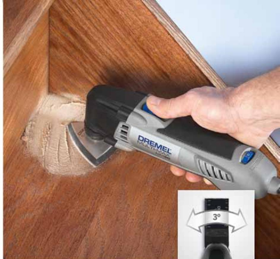
El Sistema de Herramienta Oscilatoria Dremel® Multi-Max™ ofrece a los entusiastas de la remodelación una herramienta multitarea versátil y eficaz. Con un movimiento rápido de un lado a otro, la Multi-Max™ puede realizar una variedad de proyectos que involucran reparación, remodelación o restauración.
